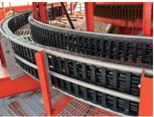
旋转拖链配合钢管式圆形导槽，应用于高粉尘、多碎渣环境
