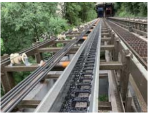
应用于户外景区观光斜行梯的拖链，耐高温及抗UV
