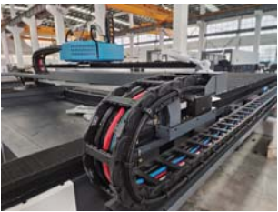
GeMotion系列特别适用于高负载高速应用如激光切割机设备
