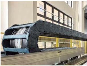
ESD拖链具有防爆防静电功能，应用于喷涂机器人
