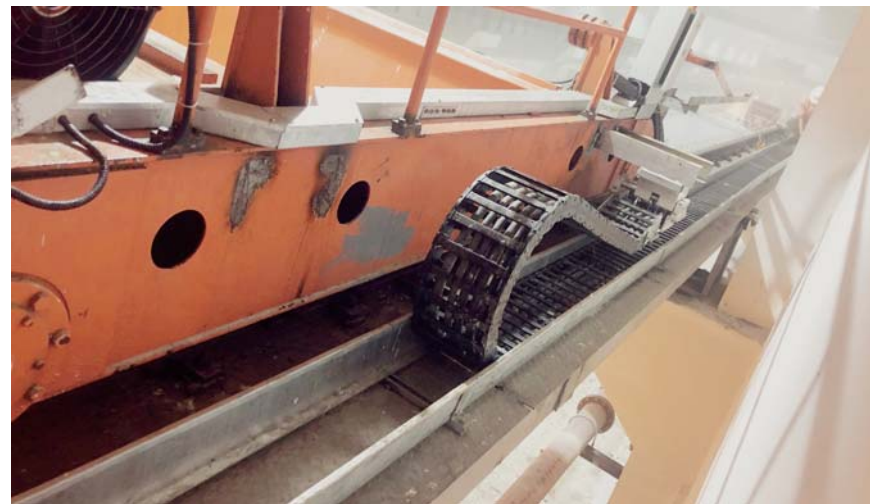
整套系统：GeMotion拖链，GuidEasy导向槽和浮动头，应用于高温高湿环境，行程138米
