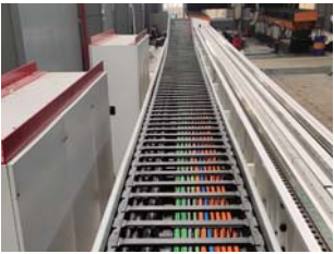
应用于龙门加工中心的拖链，内部分隔确保线缆规整、互不缠绕
