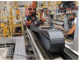
TCR60M系列应用于汽车厂七轴机器人，坚固耐用
